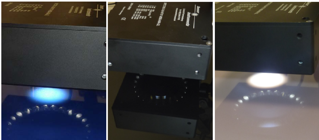
Farbmessung auf Metallplatten unmittelbar nach dem Lackiervorgang mit dem SPECTRO-3-28-45°/0°-MSM-ANA-DL
